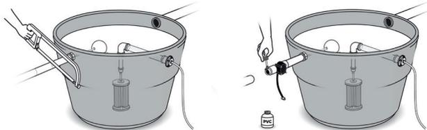
Meça a tubulação de entrada para inserir o sensor de vazão. Corte a tubulação, encaixe e cole o sensor de vazão usando cola própria para tubos de PVC.
